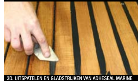
3D. UITSPATELEN EN GLADSTRIJKEN VAN ADHESEAL MARINE
